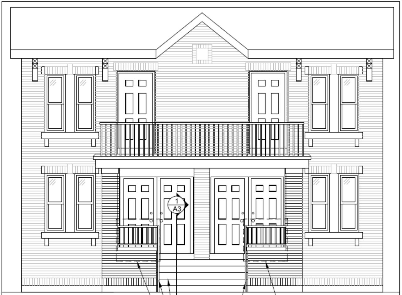
**ELEVATION DEPICTING PARTIALLY RESTORED PORCH WALL AND RAILING**
